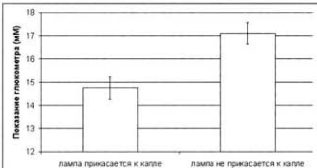
Рис. 1. Влияние способа освещения тест-полоски на показание глюкометра
